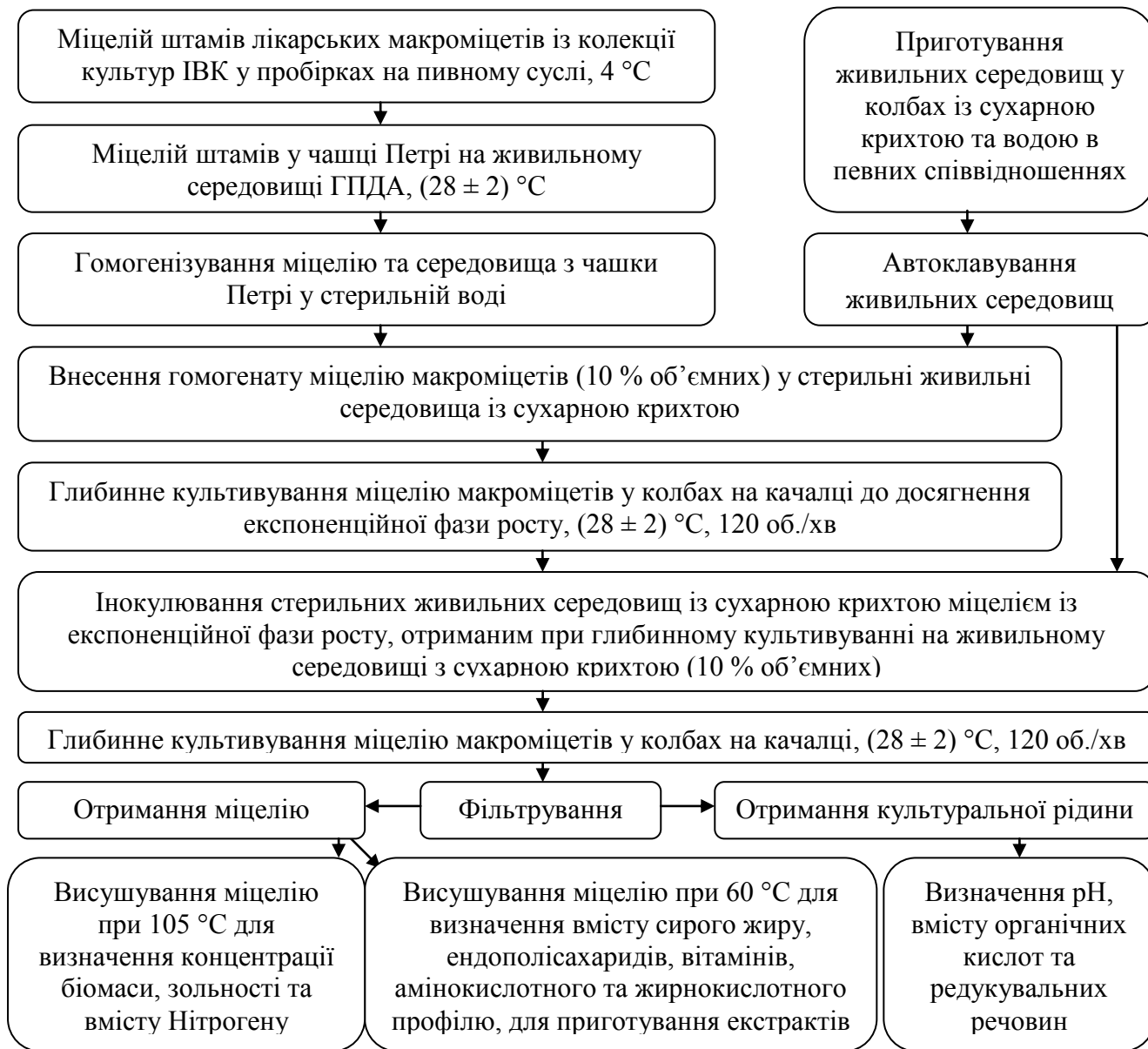
Рис. 6.2. Схема процесу глибинного культивування лікарських макроміцетів на живильному середовищі з сухарною крихтою
