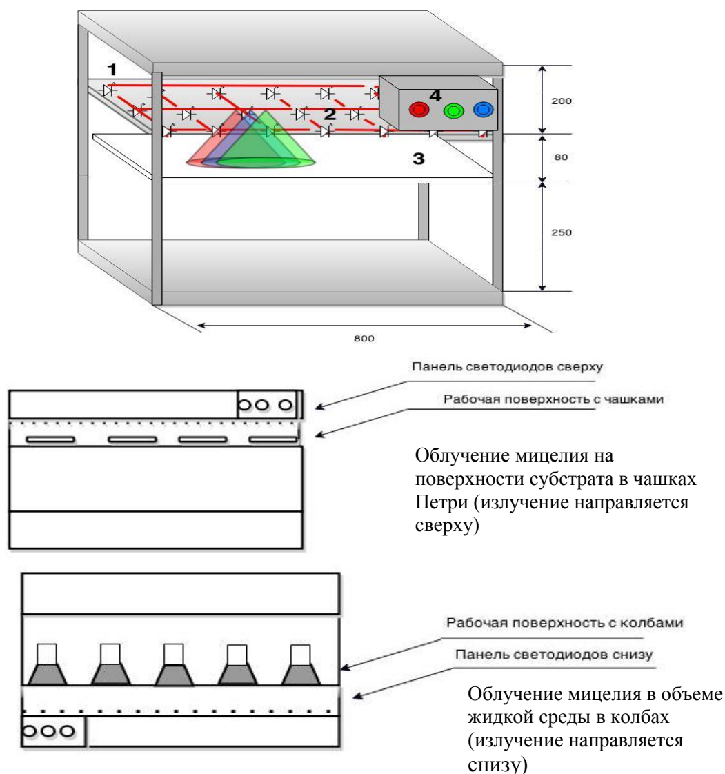
Рис. 2.3. Схема светодиодной осветительной установки для облучения макромикетов светом контролируемого спектрального состава
